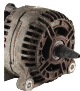
Albero rotore danneggiato
